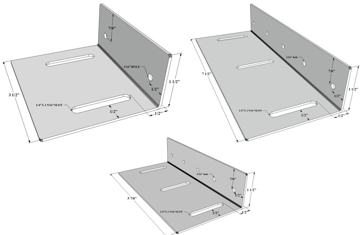
La clip à déflexion est utilisée pour permettre un mouvement de maximum 1.5" (0.75" dans chaque direction) au haut du mur.
